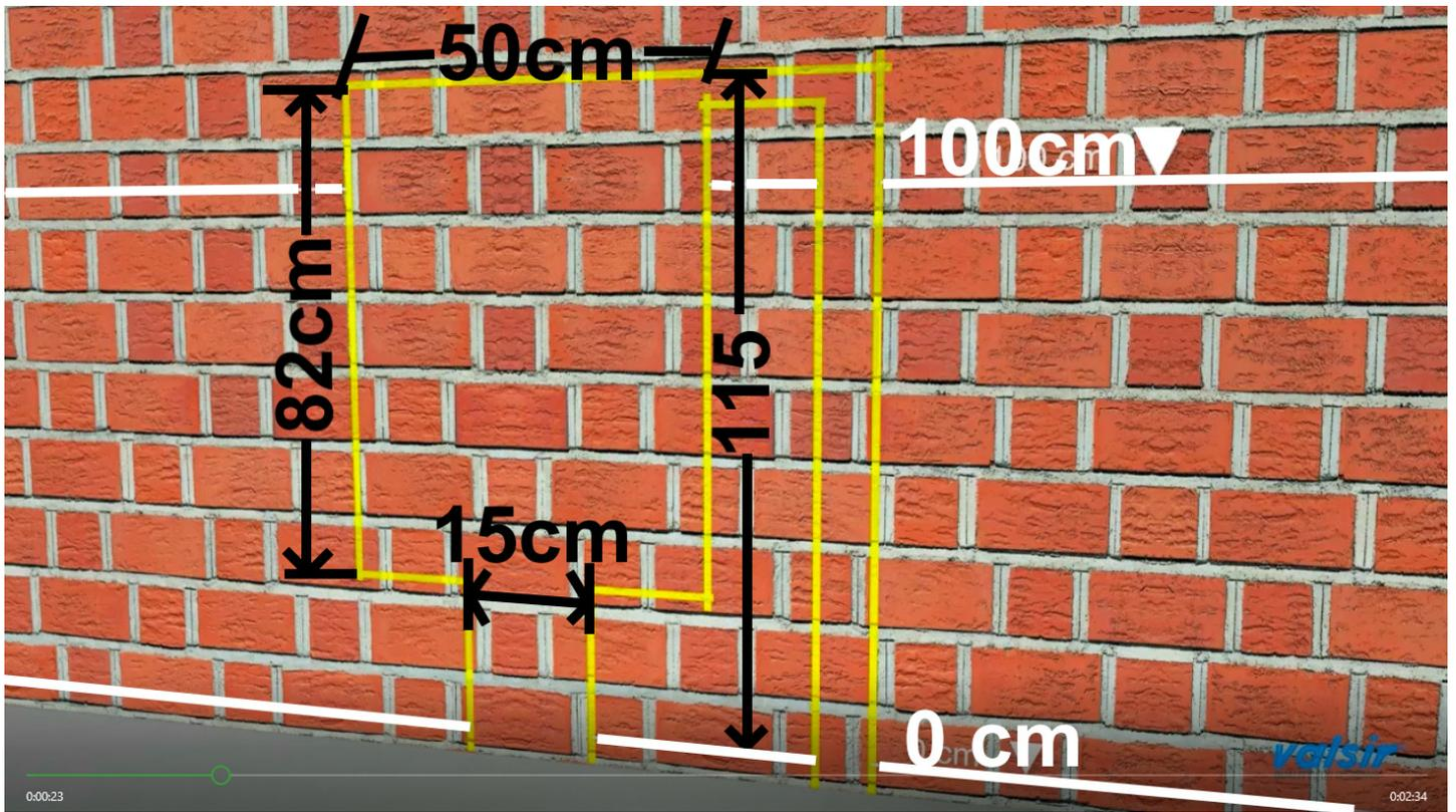
如果要鑿牆，首先請預計大概位置：確認鑿牆 - 高度為地面至頂：1150mm、水箱闊度 500mm、水箱主體高 820mm、喉位闊度 150mm、留下入水管位置；留意地面對上 1000mm 位置做個記號。
